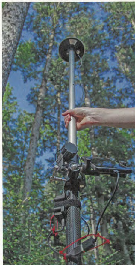
La perche GNSS offre une grande précision, mais les câbles risquent de s'accrocher aux branches.
