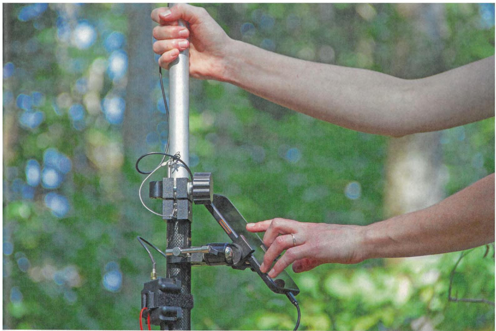
Das Smartphone an der GNSS-Stange dient sowohl als Eingabegerät als auch als Stromversorgung für das GNSS.
