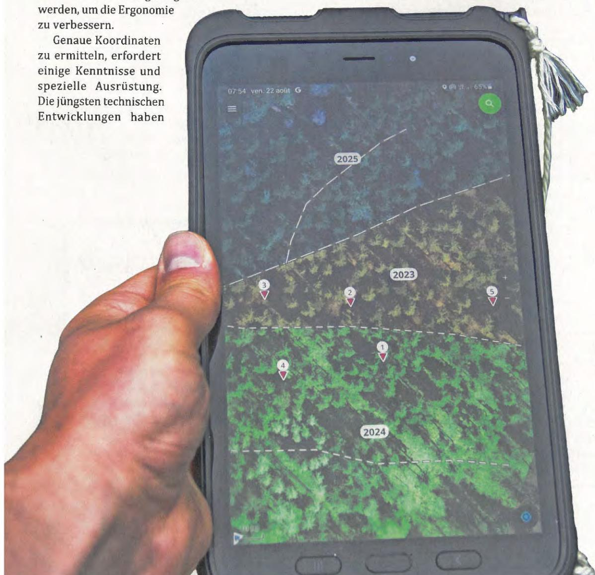
Ein über Bluetooth mit dem GNSS verbundenes Tablet bietet einen hervorragenden Arbeitskomfort: keine Kabel und einen grossen Bildschirm.
